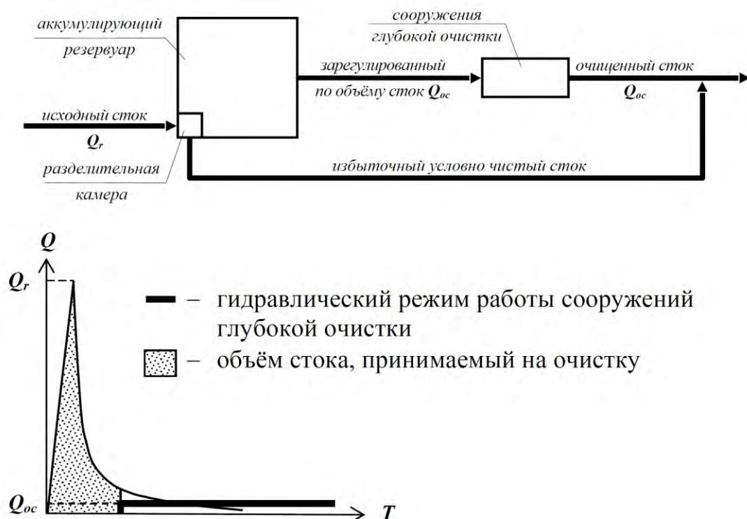
$Q$  – расход дождевых вод в расчётном створе подводящего коллектора
